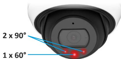
Dank der 2-Zonen Beleuchtung können Personen oder Objekte im Nahbereich sowie in entfernten Bereichen optimal ausgeleuchtet werden. Zwei LEDs sind für den Nahbereich mit breitflächiger 90 Grad Ausleuchtung. Bei einem hohen Zoomfaktor für entfernte Bereiche arbeiten eine LED mit 60 Grad für eine schmalere Ausleuchtung mit größerer Reichweite bis 50 Meter.
